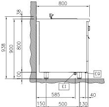
Electrical inlet (power) Equipotential screw
